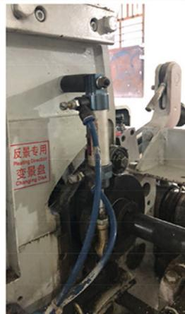
دارای پمپ پنوماتیک برای تنظیم فشار غلطک ها
